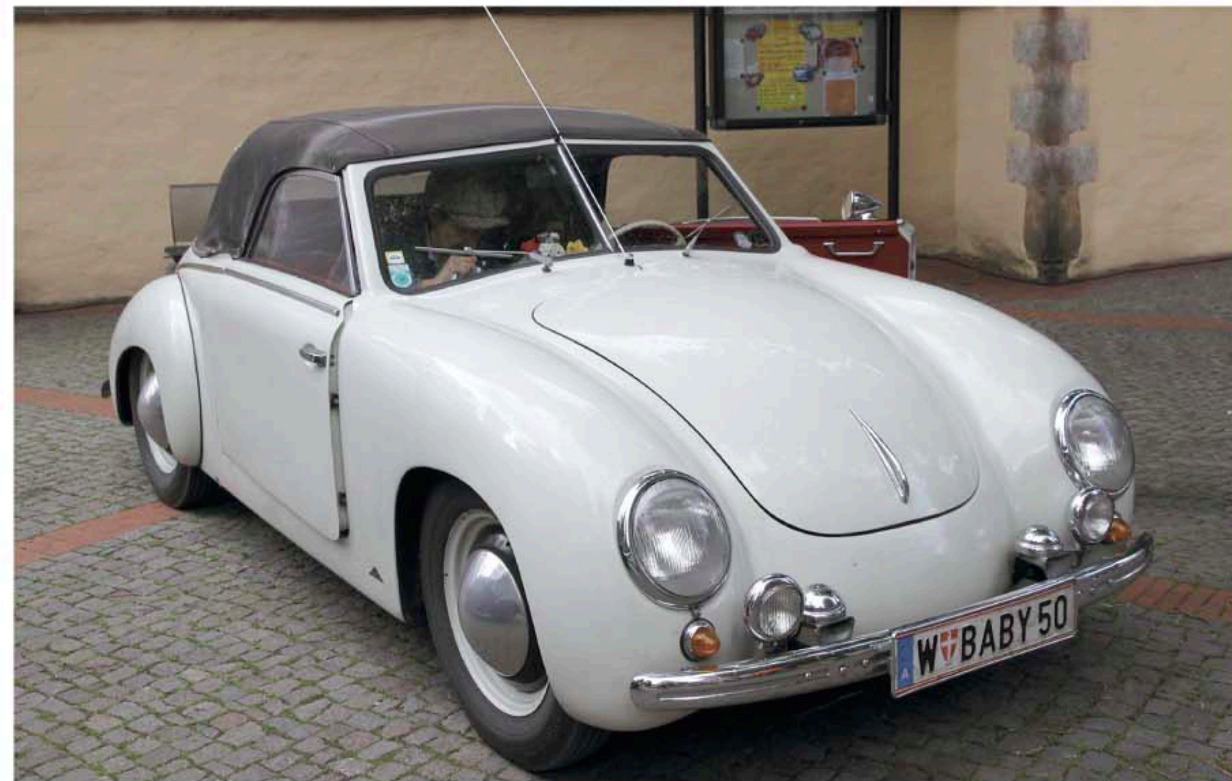
Mitte und unten: zwei weitere Cabrios des Porsche-ähnlichen Autos in unterschiedlichem Erhaltungszustand. Die hinteren Kotflügel waren ähnlich wie beim Käfer mit der Karosserie verschraubt. Nur die Türen und Hauben erhielten ihre komplette Gestalt im Presswerk.
